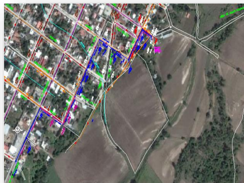
Colector Principal en la localidad de San Juan de Abajo
