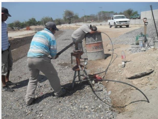
Prueba hidrostática a 10 kg en línea de Agua Potable
