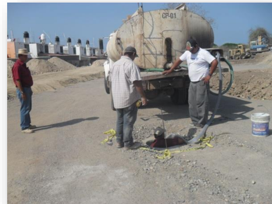
Prueba de Esgurrimiento en línea de Alcantarillado
