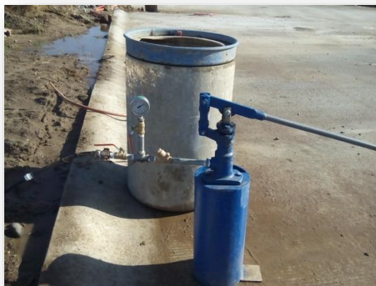
Prueba hidrostática a 10 kg en línea de Agua Potable
