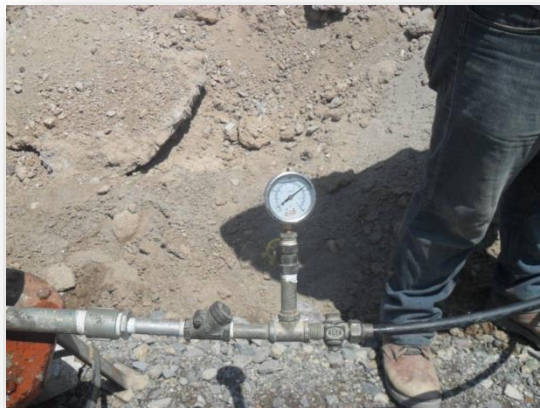
Prueba hidrostática a 10 kg en línea de Agua Potable
