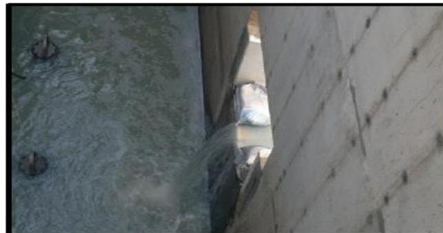
**Medición de flujo.-** Acostillamiento de la llegada del CBAC para poder realizar la medición del flujo.
