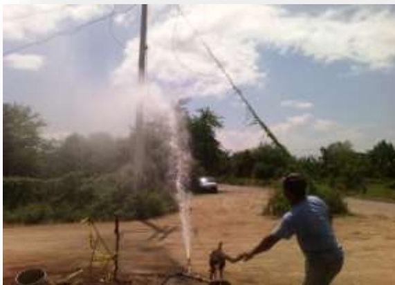
Realización de Prueba Hidrostática en tubería de PCV HCO. RD-26 de 2" y 3"
