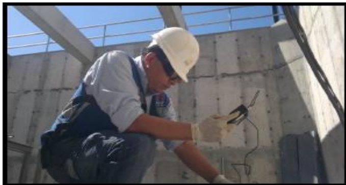
Pruebas y puesta en marcha.-Medición de parámetros a la entrada del agua a la PTAR.
