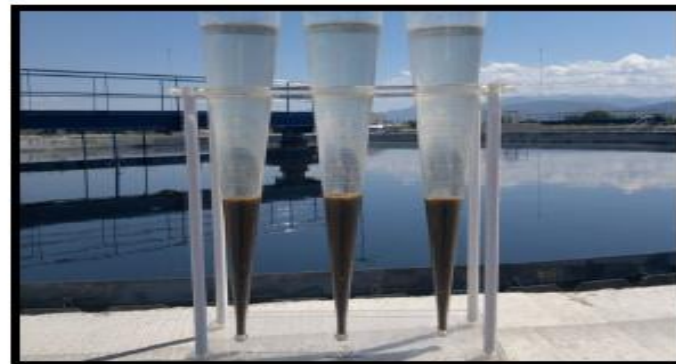
Pruebas y puesta en marcha: Aumento de los sólidos sedimentables en el reactor biológico 1.
